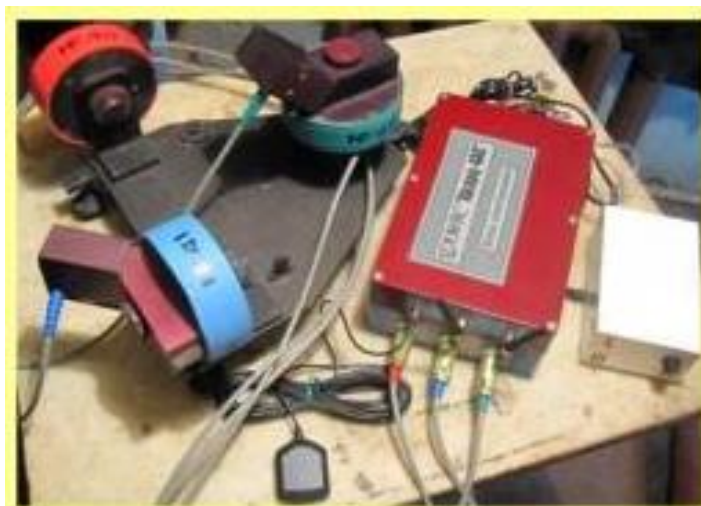
Рисунок Е.7 – Общий вид цифровой магнитовариационной автоматической станции
